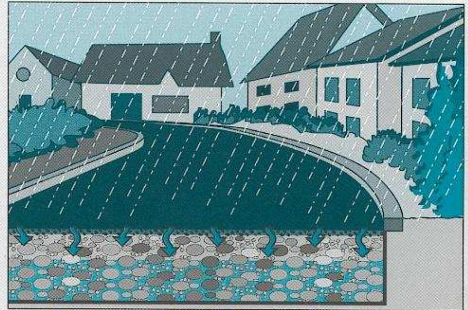
Injection de l'eau à travers un revêtement poreux
